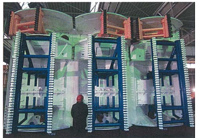
R-SWING 工法に用いられた推進機
