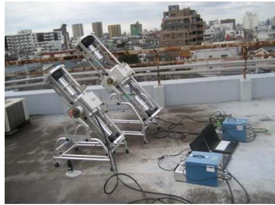
写真 3.1-2 試作機 B・C 校正試験状況
