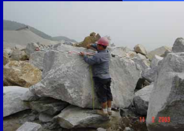
Orlanプラットフォーム周辺に設置する石の切り出し
