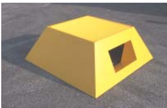
写真1 鋼板被覆モデル
