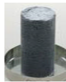
堆積物中に合成した人工メタンハイドレート
