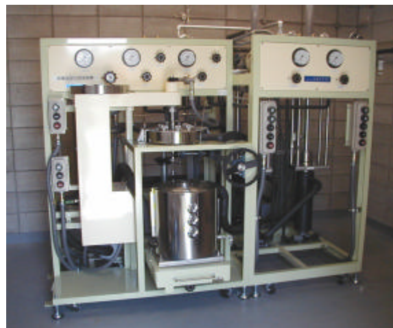
メタンハイドレート製造装置
