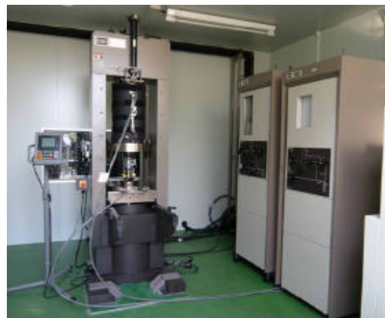
低温高圧三軸試験装置
