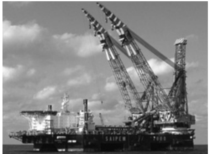
写真1 海底パイプライン敷設船(出典: Saipem社ホームページ)
