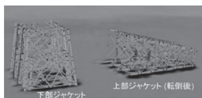
図4 海底面のジャケット横倒し残置状況(イメージ図)
