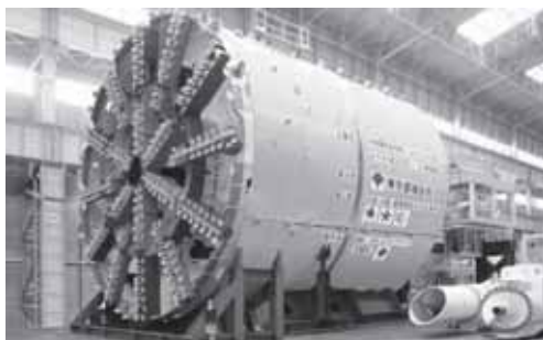
φ12.53m 泥土圧式シールドマシン
