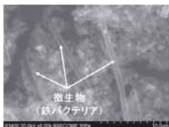
微生物(生物接触ろ過法)
