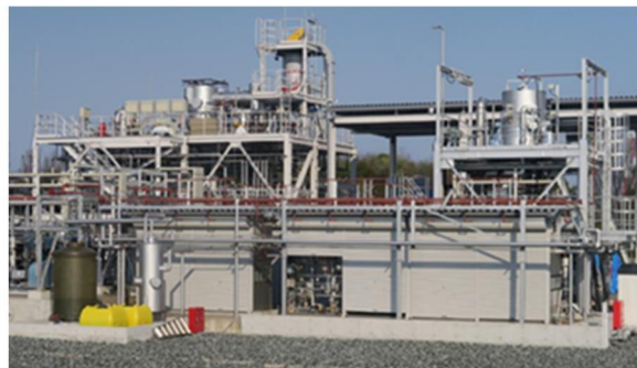
西側から撮影－(手前&右奥)FT合成設備、(左奥)ガス化炉設備
