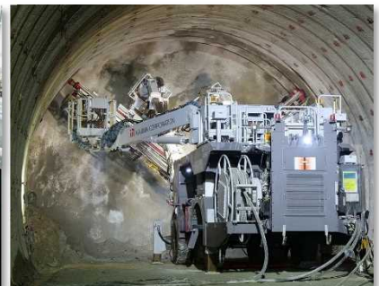
2ブームロックボルト施工機 操作画面をワンタッチで全自動施工・施工中無人の切羽
