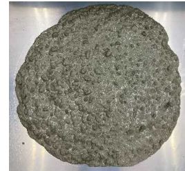
中・高流動覆工 コンクリート
