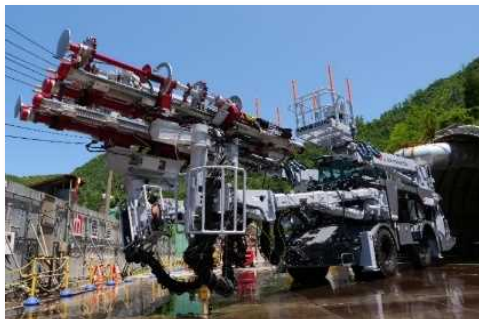
2ブームロックボルト施工機 操作画面をワンタッチで全自動施工・施工中無人の切羽
