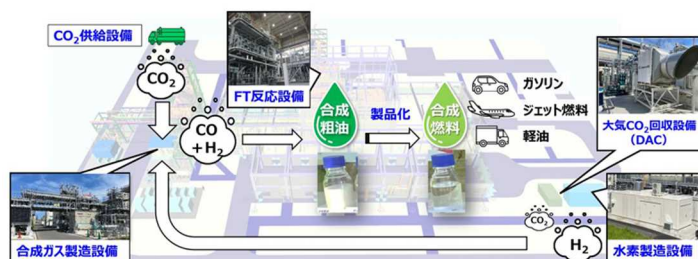
図 1 合成燃料製造実証プラント全体像
