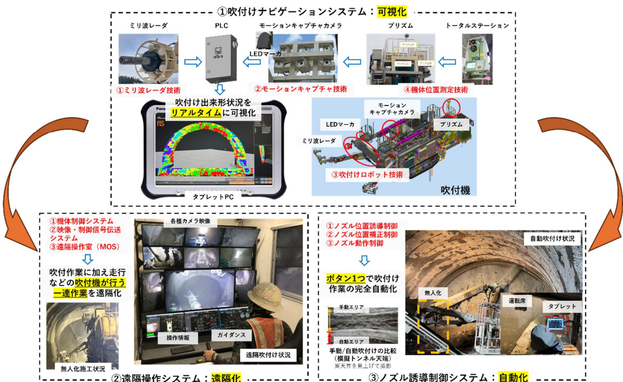
図1 コンクリート吹付け作業の遠隔化・自動化システム
