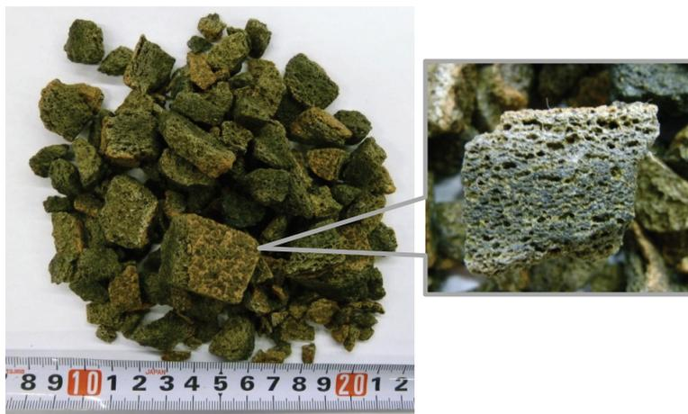
図 1.1.2-1 保水性粗骨材（グリーンビズ端材）
