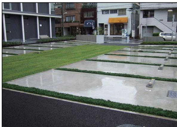
写真 4. 1. 2-2 車両走行路に適用した緑化事例
