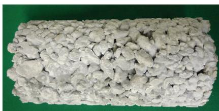
図 1.1.4-2 ポーラスコンクリート供試体
