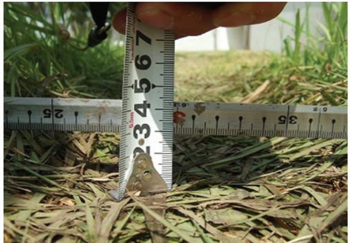
写真 2.2.4-2 轍部分の沈み込み量
