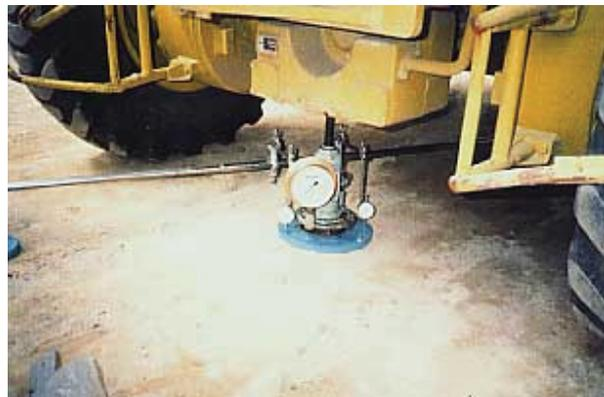
写真 2.3.1-2 平板載荷試験
