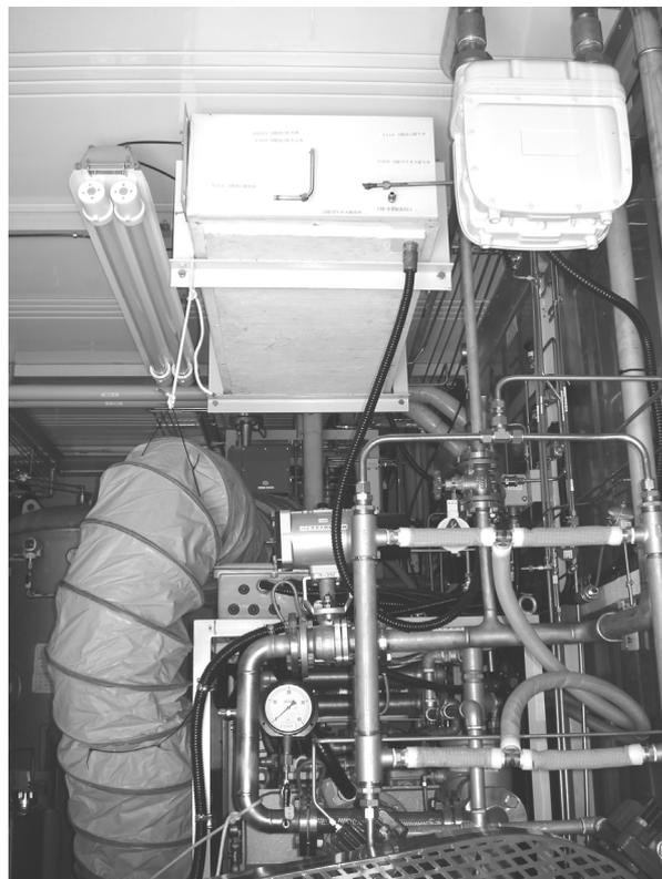
図.3-1-4 膜濃縮実証試験装置（中空知衛生施設組合リサイクルライン設置）
