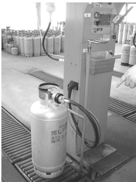
図.4-1-27 LP ガスボンベ充填機
