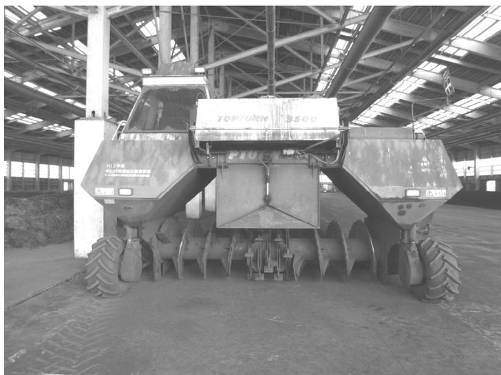
図.4-2-13 自走式大型攪拌機（緑産社製）
