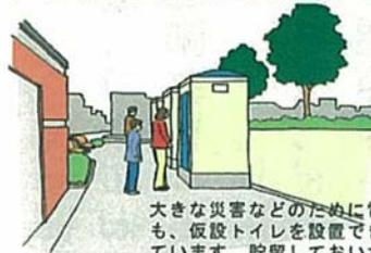
大きな災害などのために電気や水道がストップしても、仮設トイレを設置できるような配管構造になっています。貯留しておいた雨水をトイレ用水として利用します。
