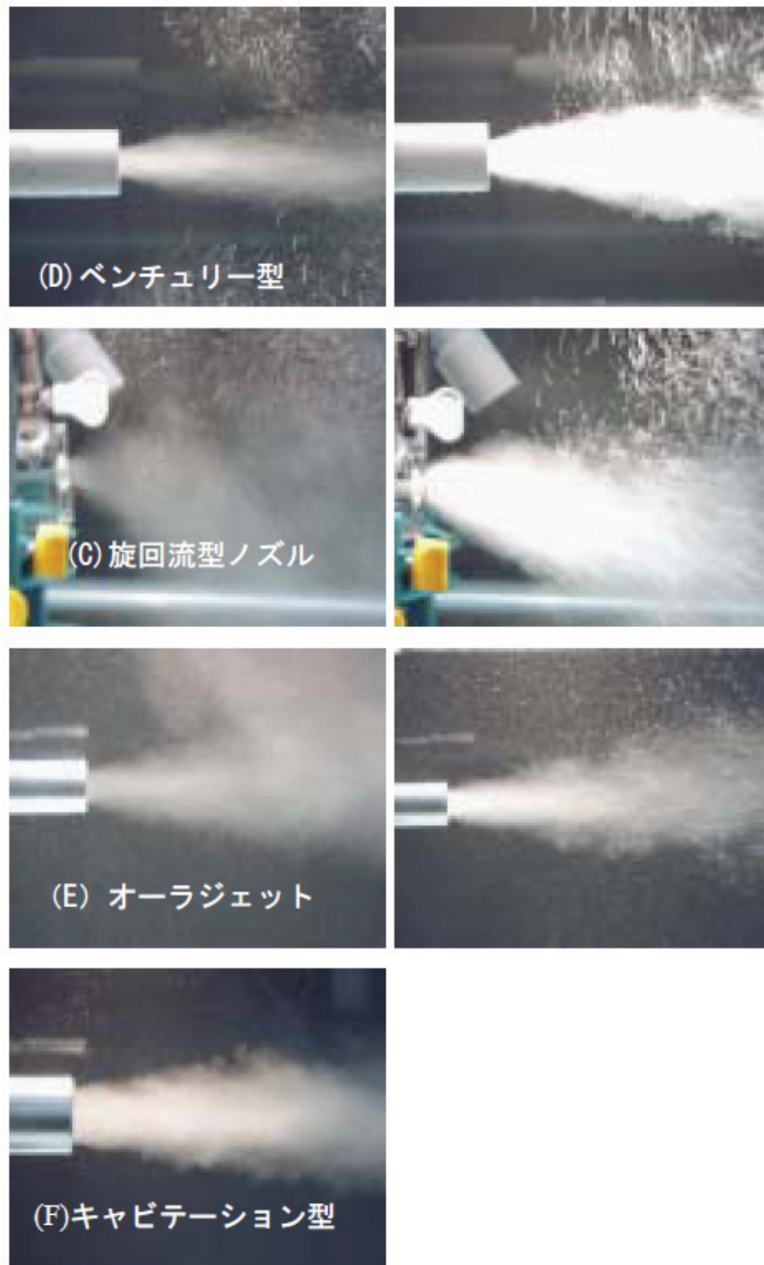
図 2.1.1-5 マイクロバブルの発生状況
