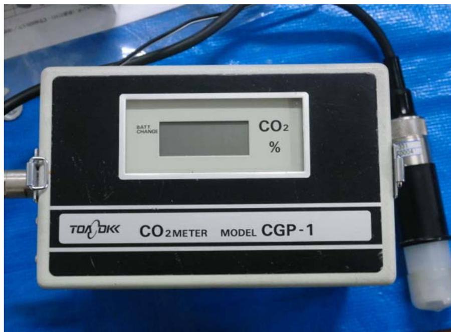
図 3.1.3-5 東亜 TDK 製炭酸ガス濃度計
