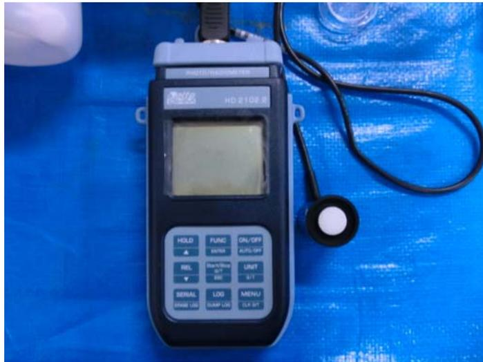
図 3.1.3-3 Delta OHM 製ポータブル照度・輝度・放射照度計 HD2102.2
