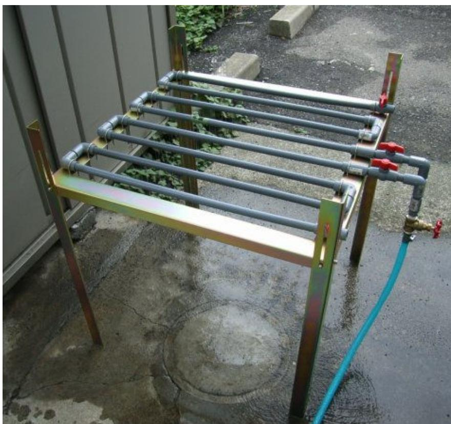
写真 3.1-1 製作した防滴試験器
