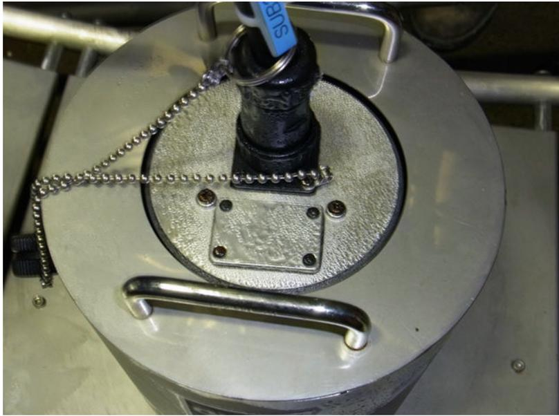
写真 4.2-2 副主検出器リアパネルおよび防滴コネクタの結露状況
