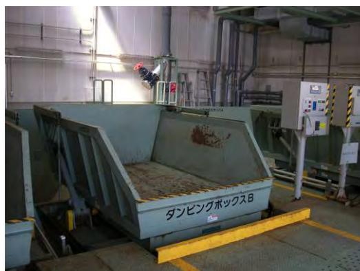
写真 5.1-3 農作物収穫残さタンピングボックス
