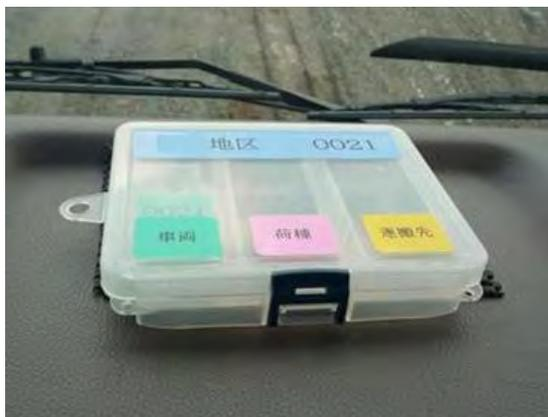
写真 3.2-4 車両に搭載されたICタグ
