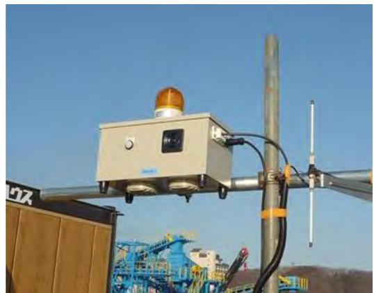
写真 3.2-3 ICタグ読取アンテナと表示灯
