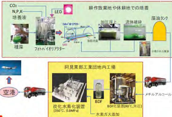
CO<sub>2</sub>, N, P, K 培養液, LED, 種藻, フトハイオリアクター, 26m<sup>2</sup> x 177cm, 浮遊培養, 加圧浮上, 流体破碎, 藻油タンク, 分離された藻油, 分取された藻油, 同見東部工業団地内工場, 炭化水素化装置 (350°C, 0.8MPa), BDF, BDF化装置 (80°C, 常圧), 水素ガス添加, メチルアルコール, 空港
