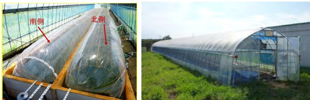
写真 5.4-1 温室内に設置したフォトバイオリクター (30m<sup>3</sup>)
