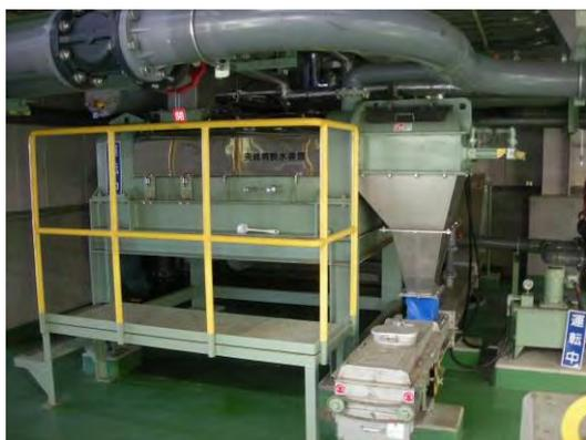
写真 5.1-6 夾雑物脱水装置
