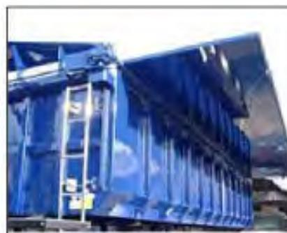
写真 2.4.3-3 天蓋式コボレーンを設置した 10t ダンプ
