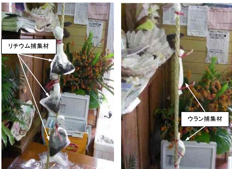
図 3.4-4 西表島に設置したリチウム捕集材（左）とウラン捕集材（右）
