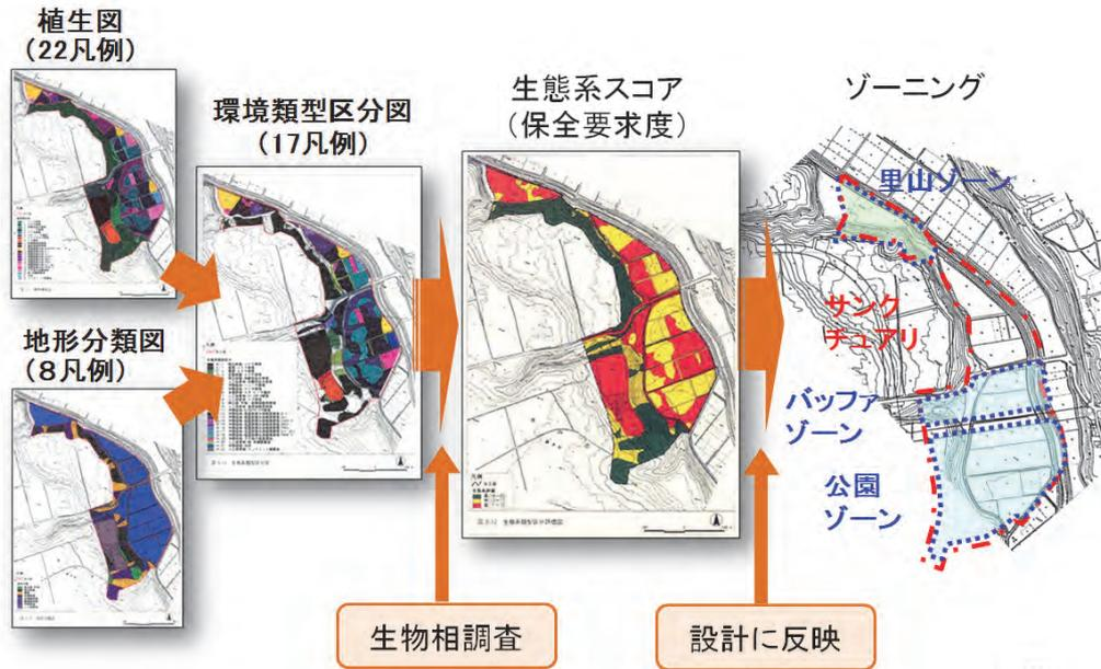
図 4.2-28 環境類型区分に基づく保全要求度の評価と調整池の設計
