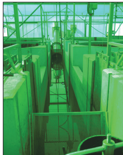
写真 7-4 魚を一度に捕獲する仕組み
