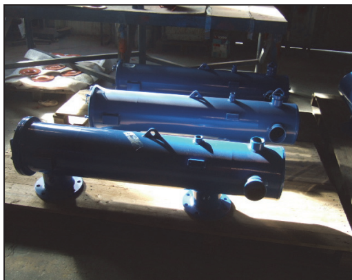
写真 4-8 逆洗浄自動化フィルタ
