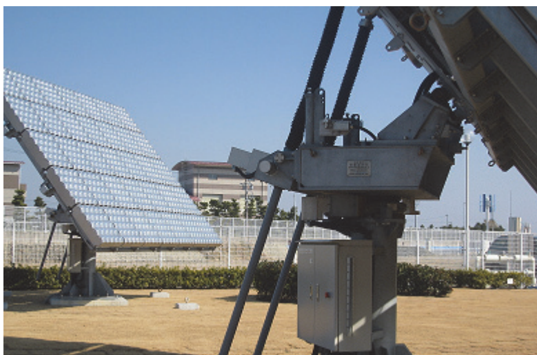
写真 1.2.1-2 集光型太陽光発電装置の駆動装置
