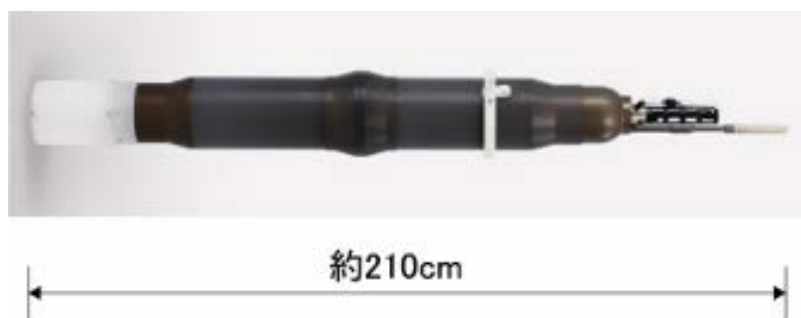
図 2.2.2.2-1 榊鶴見精機製 Deep NINJA 外観 (榊鶴見精機ホームページより引用)
