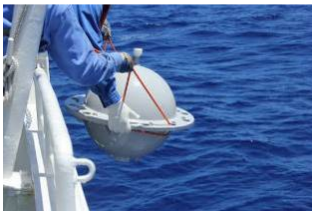
図 2.2.2.1-1 ブイロボット外観 (現行タイプ、気象庁のホームページより引用)
