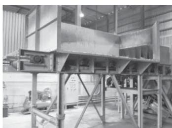
写真 5.5-10 樹皮破砕機
