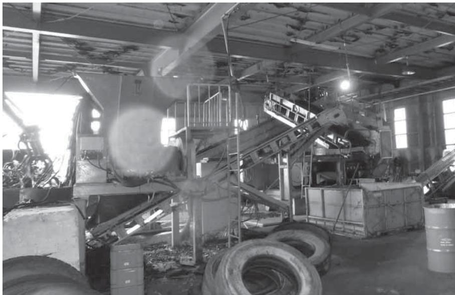
写真 3.1.2-4 タイヤ専用大型破砕機
