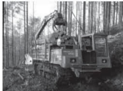
写真 参考資料-19 大型フォワーダ 積込・運搬状況
