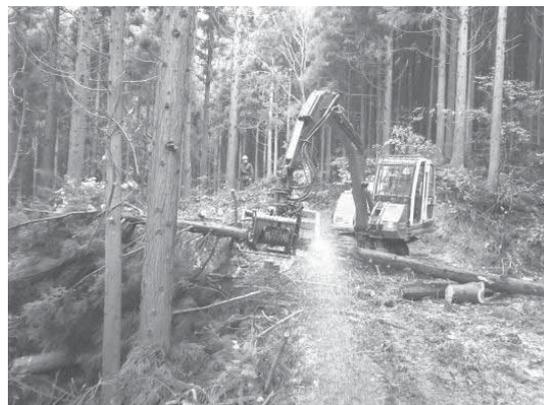
写真 参考資料-13 プロセッサによる造材状況
