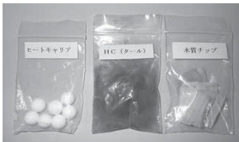
写真 5.4-2 熱媒体(アルミナセラミックボール)と原料(木質チップ)
