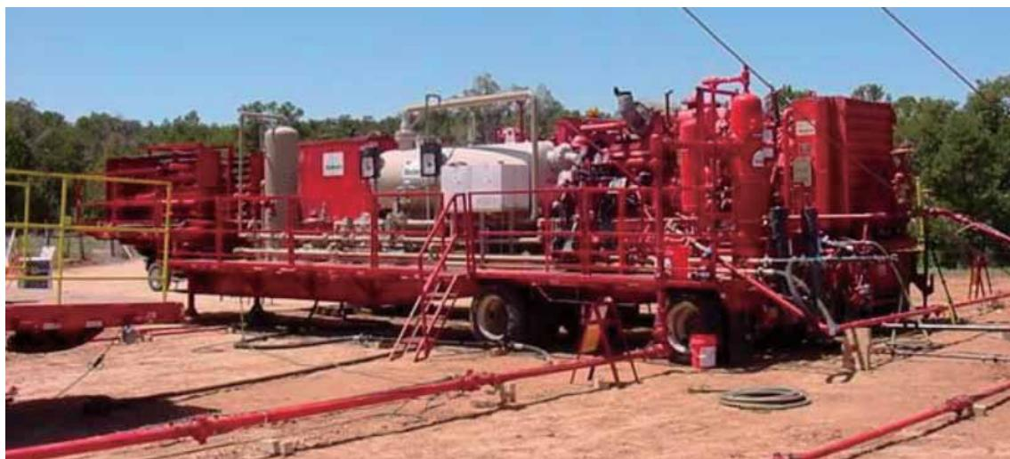
図 2.4.8.2 可搬型 REC<sub>s</sub> (Reduced Emission Completions) 装置
