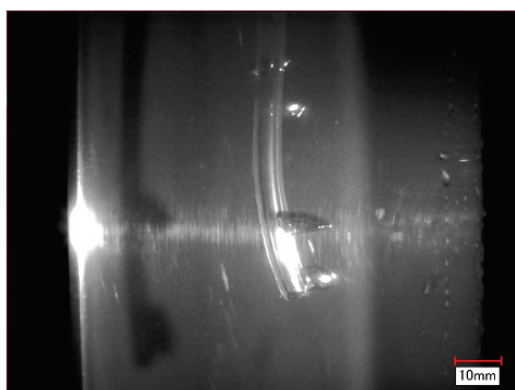
写真 4. 1-8 パイプ \text{CO}_2 注入状況
