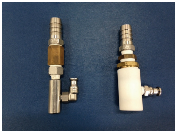
写真 4.2-5 マイクロバブル発生ノズル（左：300ml/分用、右：1000ml/分用）
