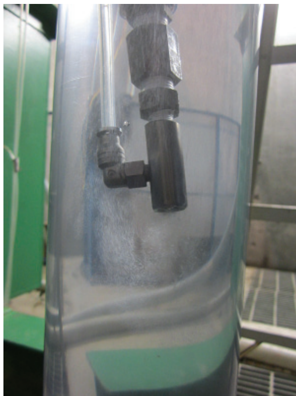
写真 4. 2-3 透明アクリル管内での CO 2 マイクロバブルの発生状況
