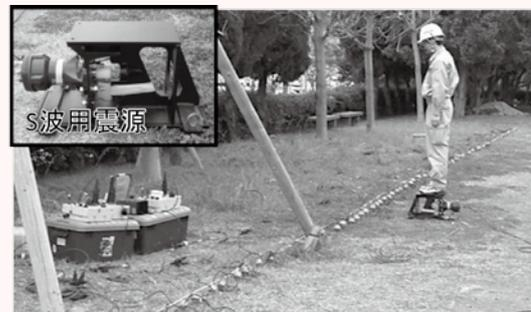
図1 測定の様子とS波用震源装置
