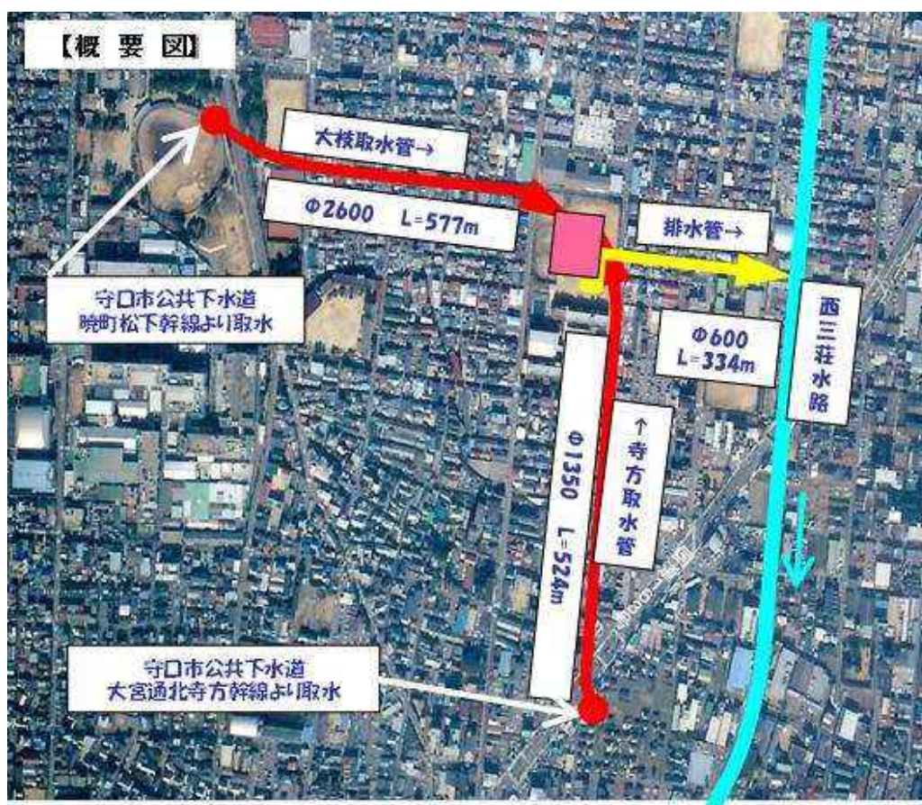
図 4.4.4-1 西郷通調節池の概要図
