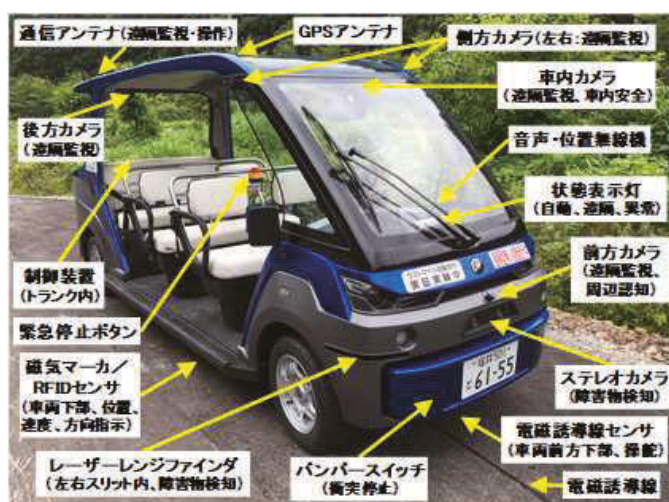
図 4.2.4-2 自動運転小型電動カート 出典：(国研)産業技術総合研究所 15)
