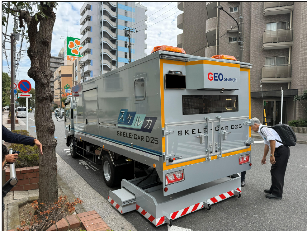
図 3-4 車載型高速 GPR 探査システム（スケルカー）
