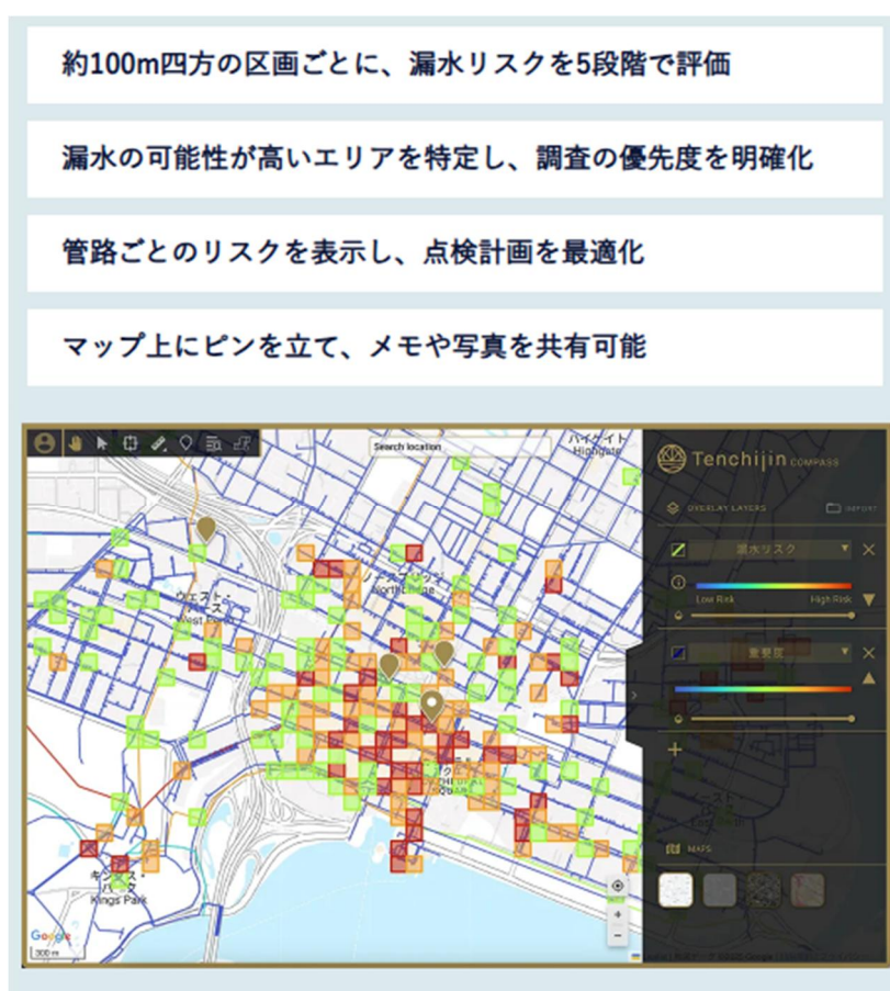
図-2 漏水リスク評価に基づく音聴調査支援
