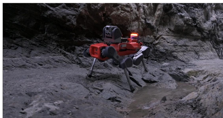
図 5-18 四足歩行ロボット ANYmal による湿潤・不整地での作業 67
