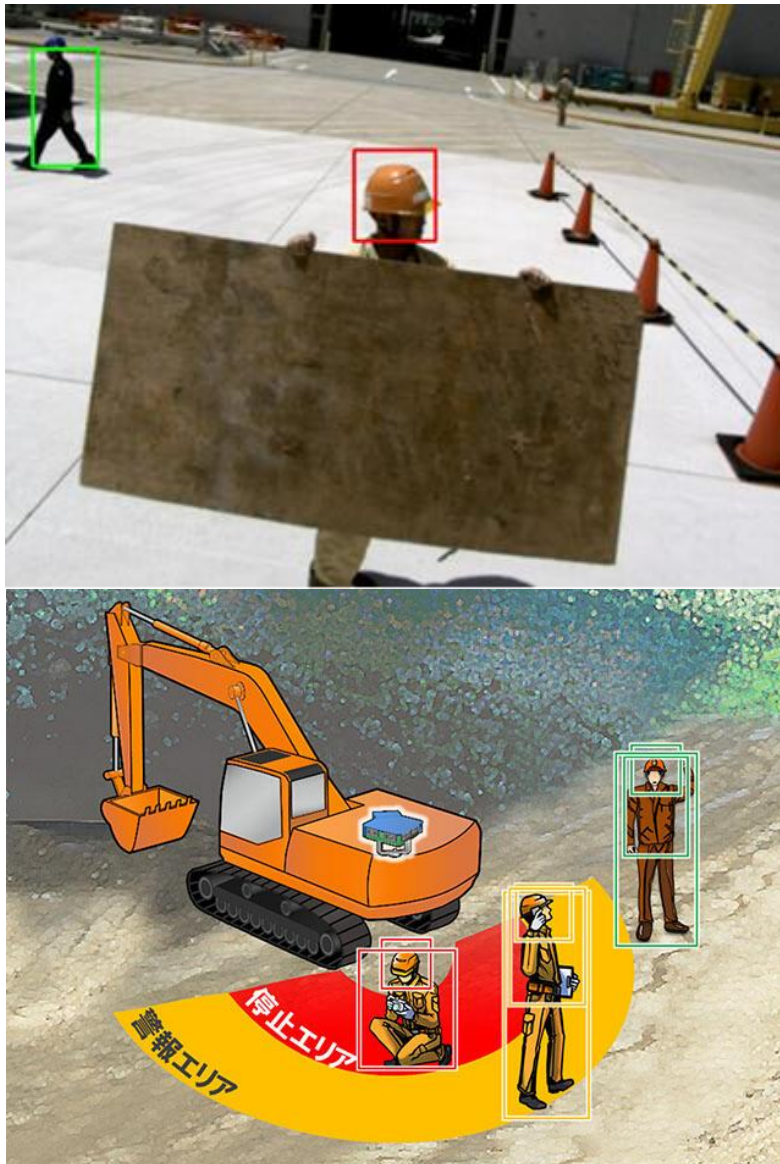
図 4-15 上：作業員の接近を検知 下：警報エリアと停止エリアの設定イメージ 44
