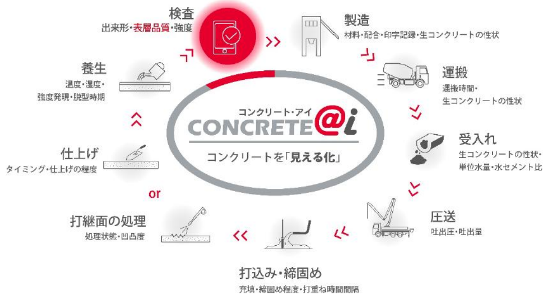
図 4-12 コンクリート・アイ概念図 42
