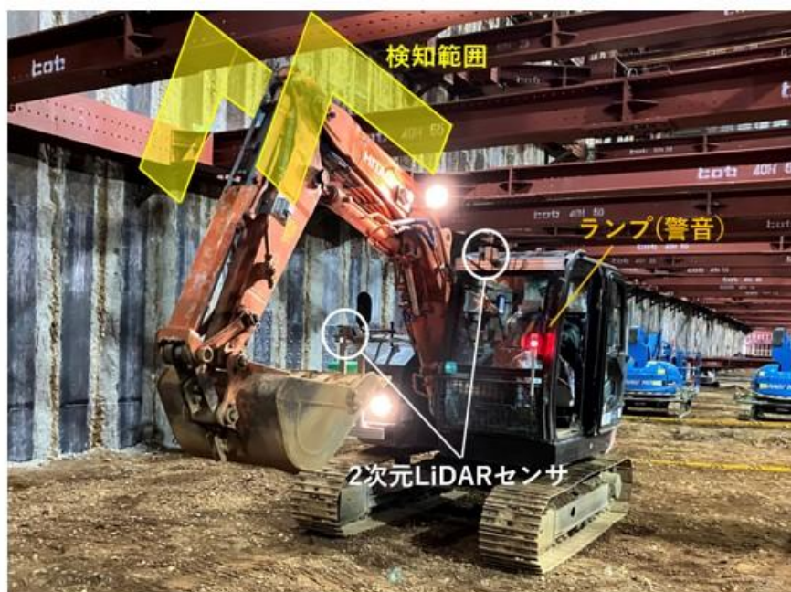
図 5-8 バックホウの衝突防止システム 57
