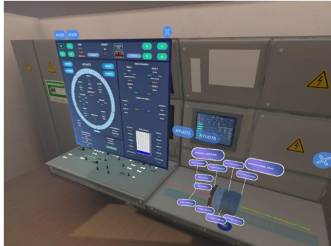
図 5-17 TBM Control Centre の VR イメージ 66
