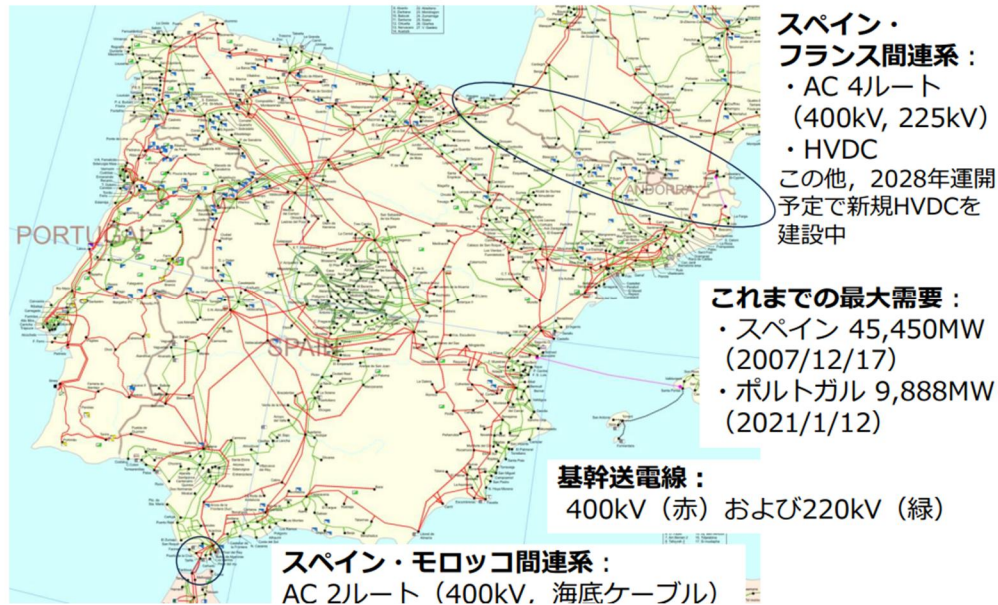
図 5-25 スペインの高圧送電網 75
