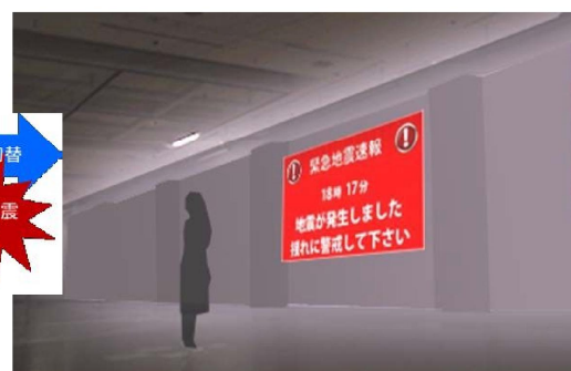
図2.17 プロジェクターを利用した災害情報発信可能なデジタルサイネージのイメージ
