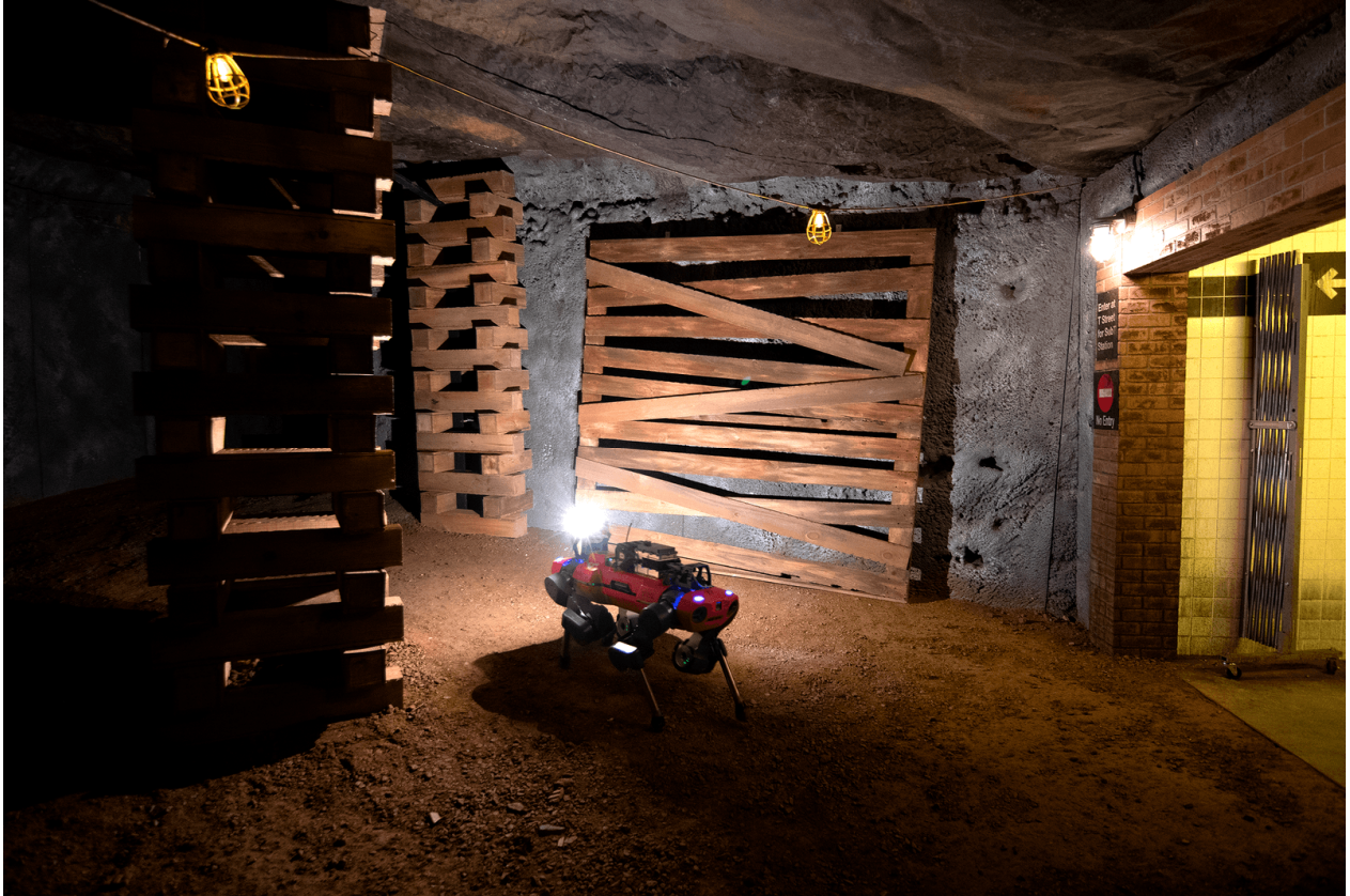
図 7-2 コースに進入する四足歩行ロボットの例 35 (DARPA SubT Challenge、チーム Cerberus の ANYmal)
