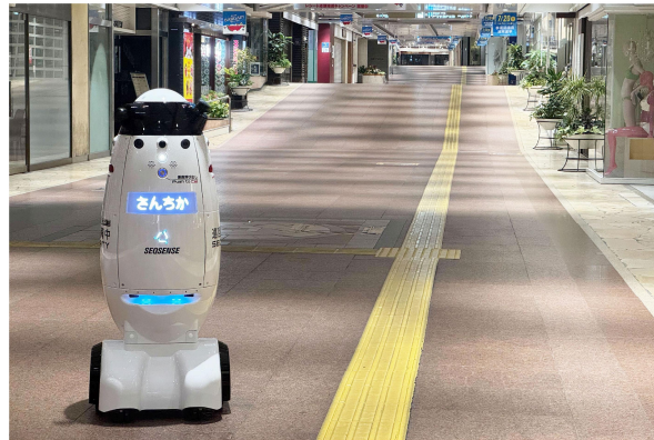
図 5-12 自動移動型警備ロボット
