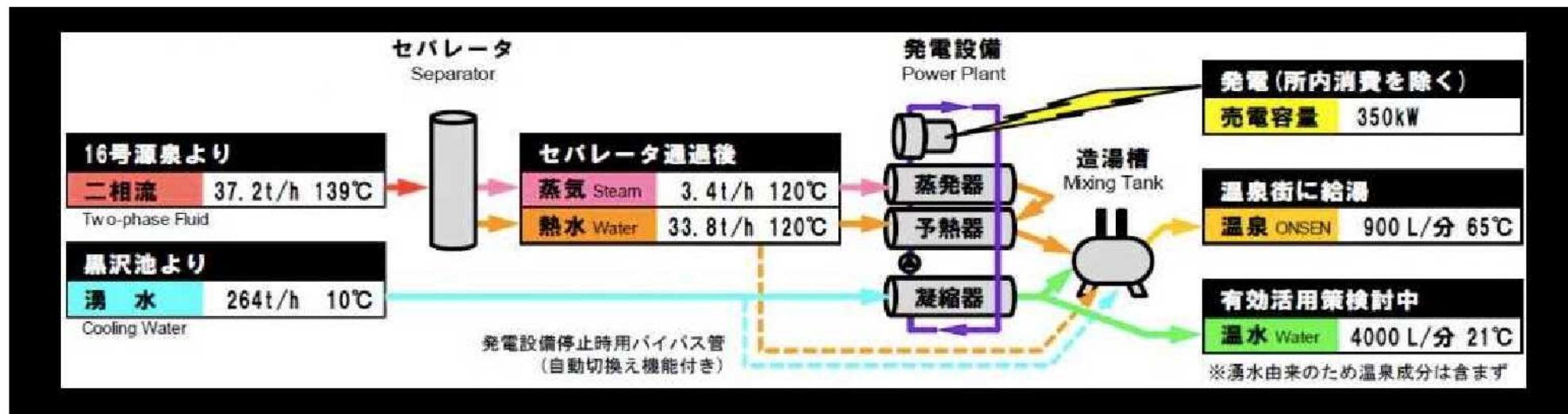
滝ノ上温泉生産井の噴出試験結果 (2016.5.30測定)
