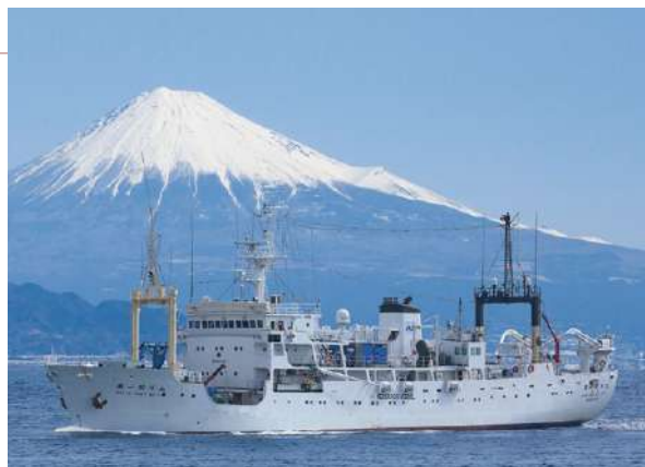
「第一開洋丸」(1,390トン) ROV、ナローマルチビーム、サブボトムプロファイラー、DPS等を搭載する主力の調査船
