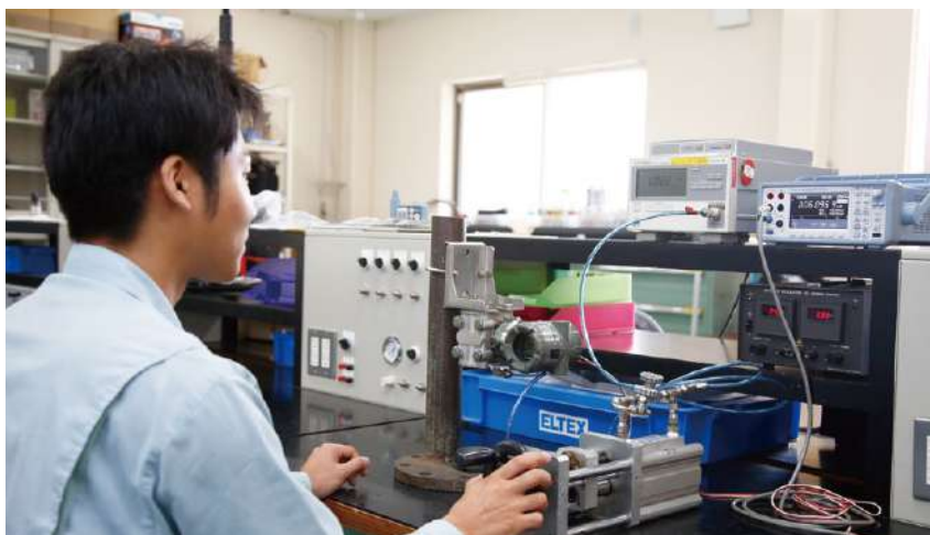
計器整備室における圧力計の校正作業
