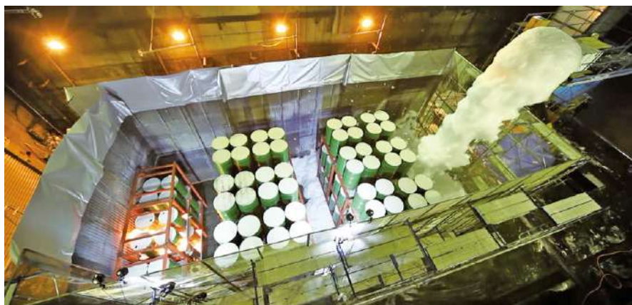
高発泡消火設備（Perf-Ex：パーフェックス）実大実験
