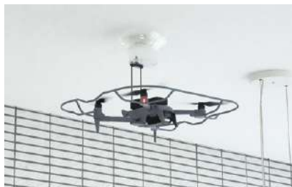
ドローンを活用した煙感知器の加煙試験器を開発
