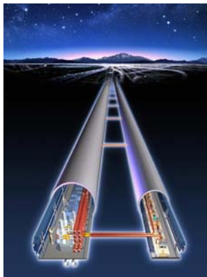
リニアコライダーの 完成イメージ図。 全長約 40km 地下 100m の トンネルの内部に超伝導 加速空洞が設置される。
