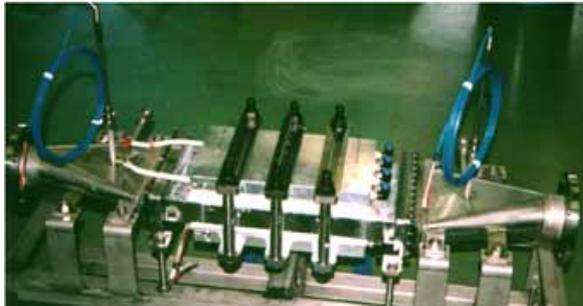
図1 移動体用熱電変換システム
