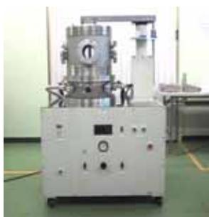
図2 熱電モジュール評価装置の概要と外観
