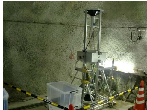
地下 300m にあるミュオン粒子計測器
