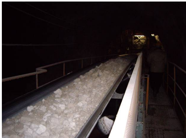
ベルトコンベアによる石灰石の搬送状況
