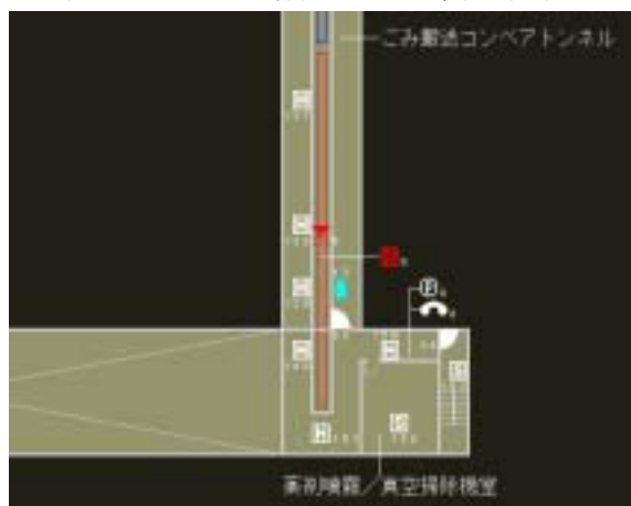
図 3.2.5-9 水噴霧消火設備の放水
