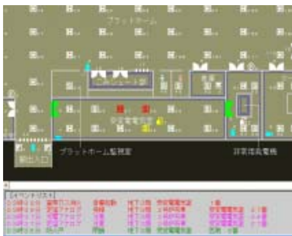
図 3.2.5-5 窒素ガス消火設備の起動
