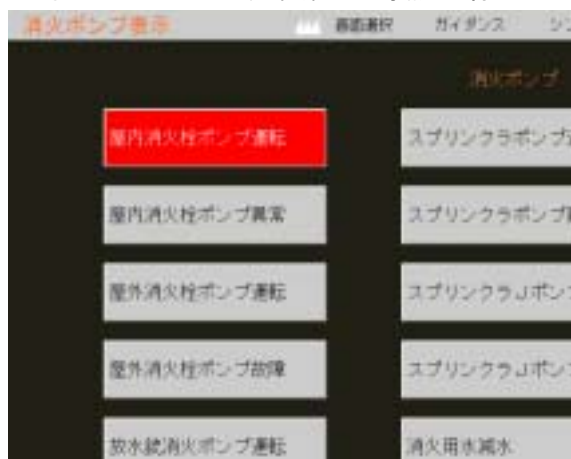
図 3.2.5-32 消火ポンプ表示画面
