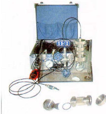
写真 3.1.4-1 小型加圧ろ過試験機
