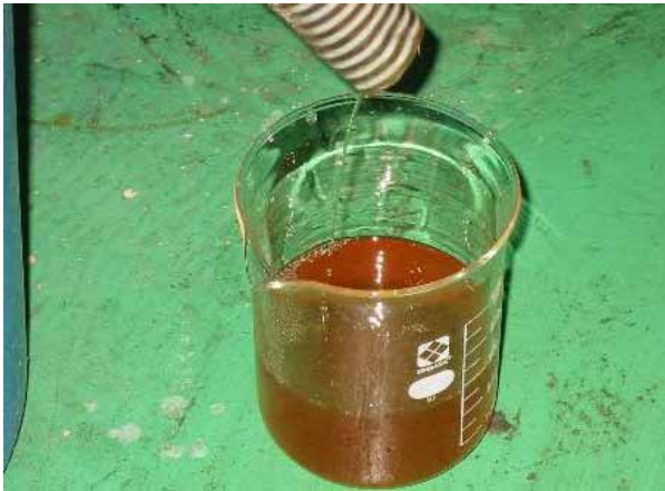
写真 3.2.4-2 H15 年度酵素無添加懸濁液 ろ液回収状況（約 7\text{L}/\text{m}^2\cdot\text{hr} ）
