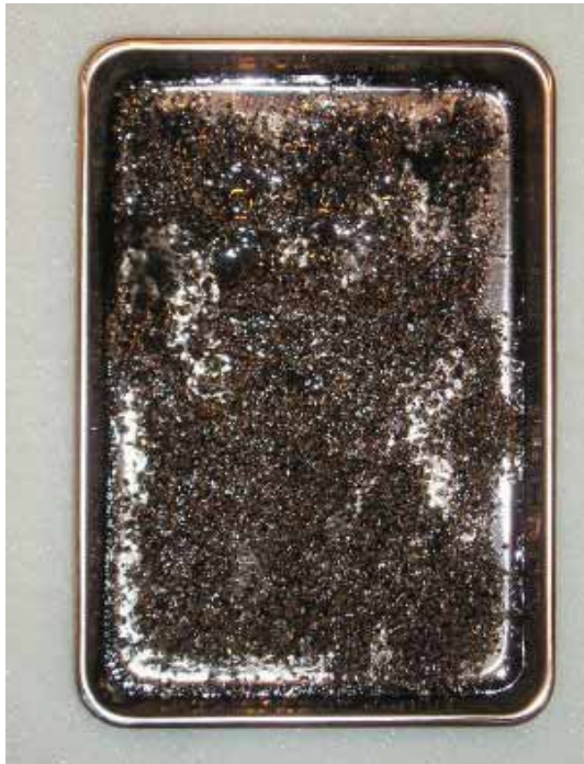
写真 3.3.4-6 クリンカアッシュ B 含浸すべり止め材 4 hr 後
