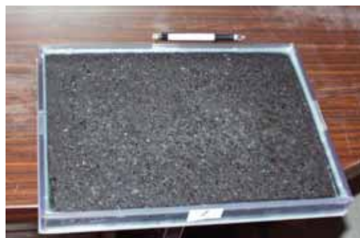
写真 3.3.3-2 アスファルト舗装路面試験体
