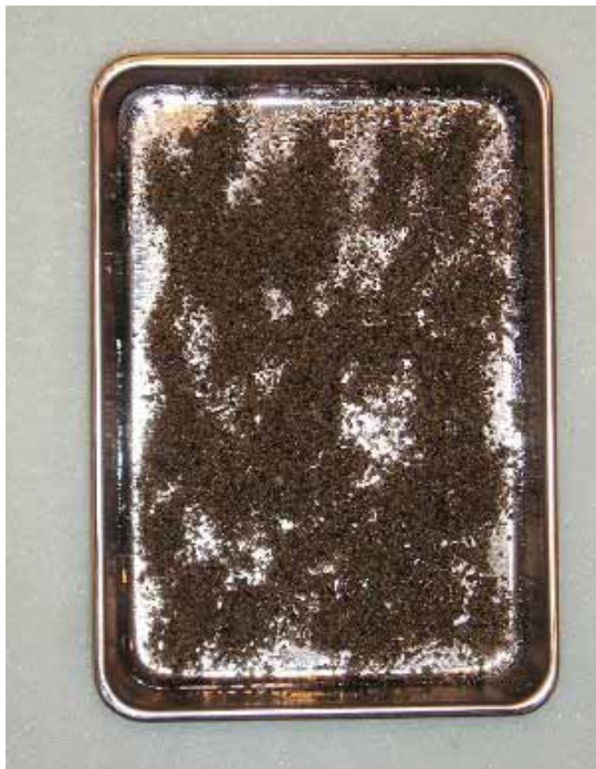
写真 3.3.4-5 クリンカアッシュ A 含浸すべり止め材 4 hr 後
