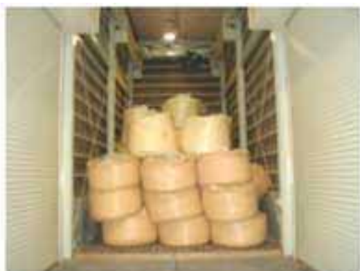
写真 3.3.5-5 フレキシブルコンテナバッグでの 融雪粒剤（凍結防止剤）保管状況
