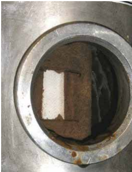
写真 3.2.4-4 固形残さ付着状況
