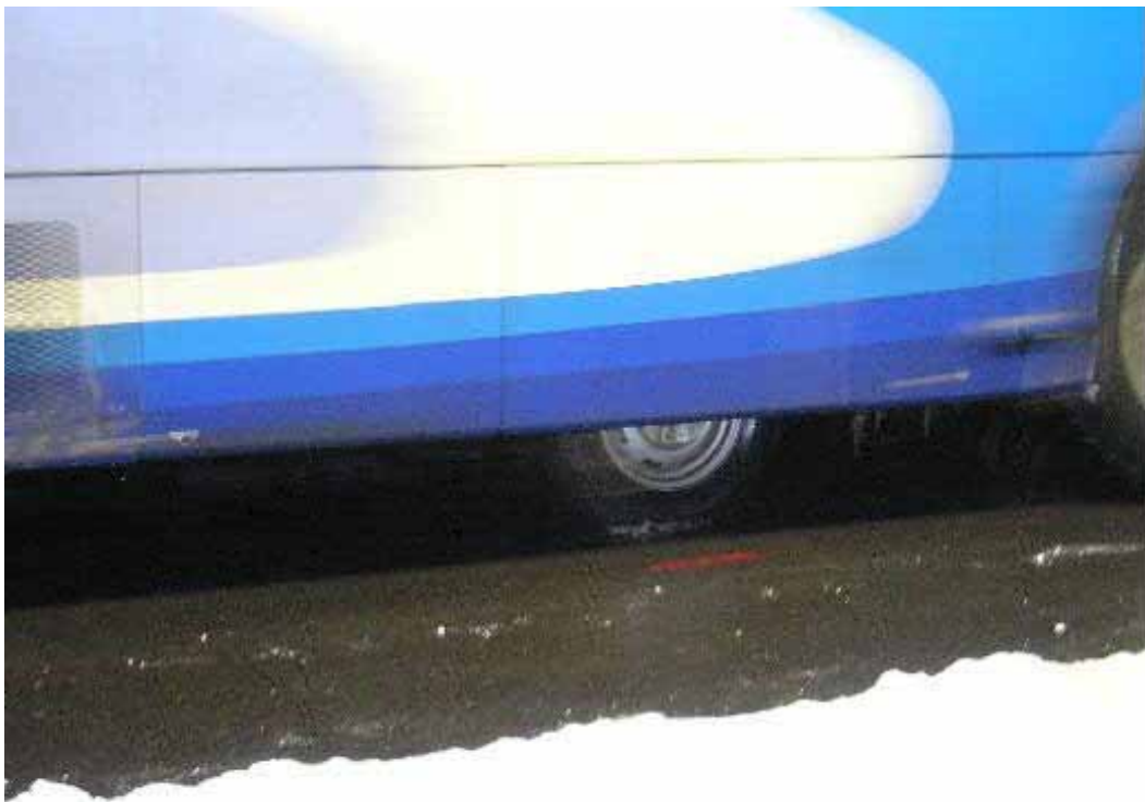
写真 3.3.3-6 すべり抵抗測定状況（測定タイヤ）
