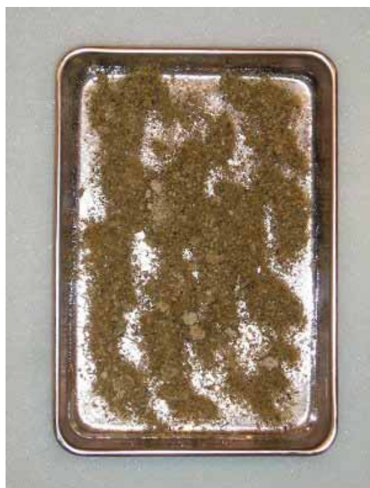
写真 3.3.4-4 天然ゼオライト 含浸すべり止め材試作品 4 hr 後
