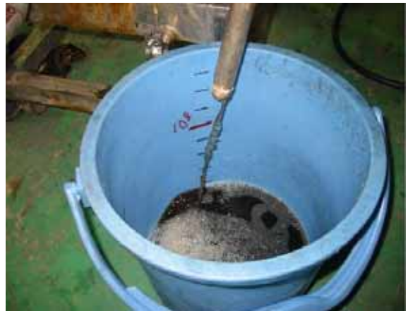
写真 3.2.4-3 H16 年度酵素添加懸濁液 ろ液回収状況（約 300\text{L}/\text{m}^2\cdot\text{hr} ）
