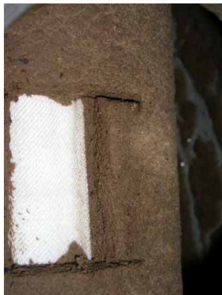
写真 3.2.4-5 固形残さ付着状況
