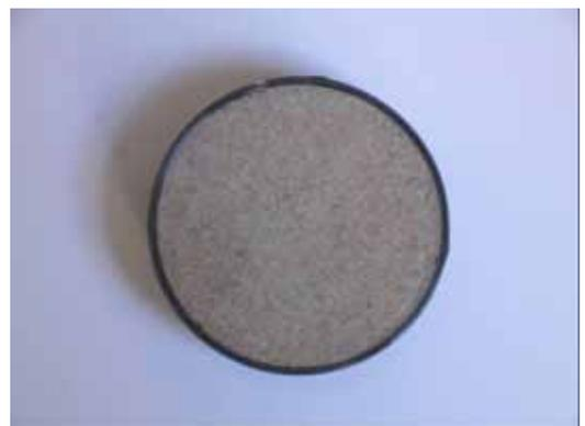
図 3.3.3-3 プラスチックシャーレ内で成型した模擬汚染土壌試料
