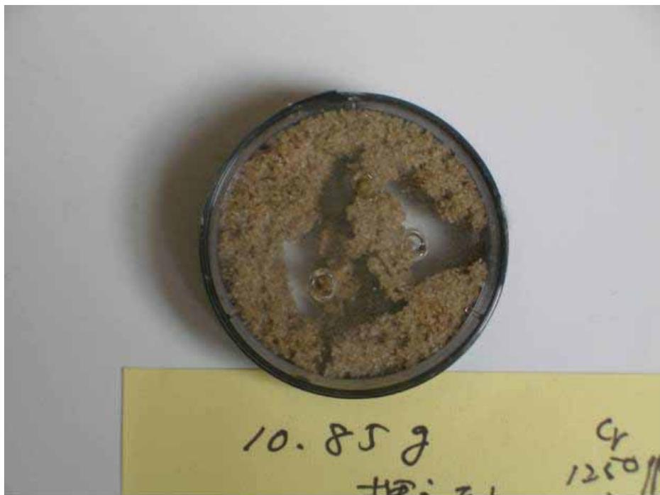
図 3.3.8-6 締固め度が小さい試料の外観
