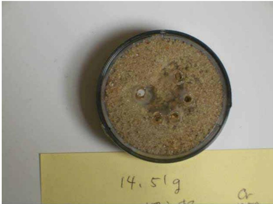
図 3.3.8-5 締固め度が中程度の試料の外観
