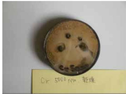
図 3.3.3-4 プラスチックシャーレ内で成型した模擬汚染土壌試料（粘性土）
