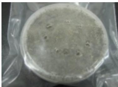
図 3-2-2 実汚染土 A（砂質土、含水状態）
