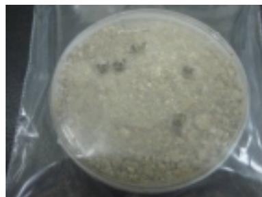
図 3-2-3 実汚染土 B（粘性土、乾燥状態）
