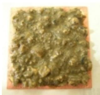
図 3-2-11 サブターゲット板に高含水土を付着させた状態
