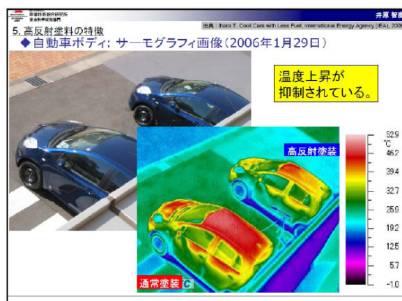
図 2.4.1-2 高反射塗料による表面温度上昇抑制効果（井上，2008 より引用）
