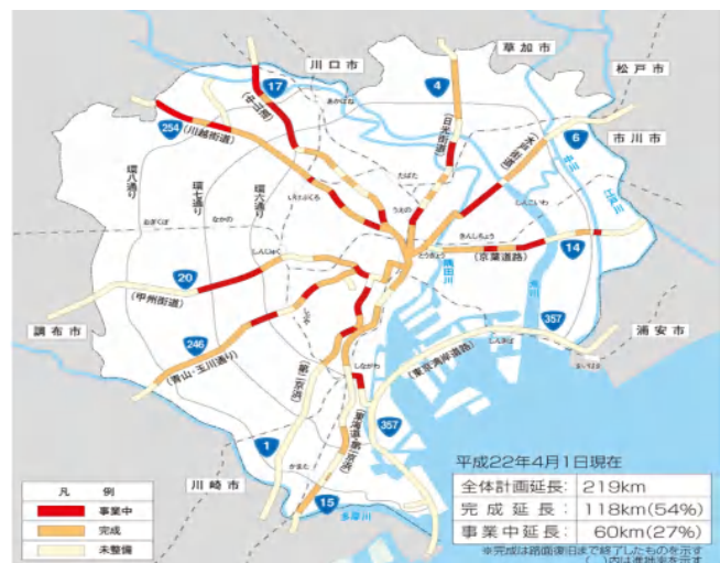
図 3.3-4 東京中心部の電線共同溝整備状況
