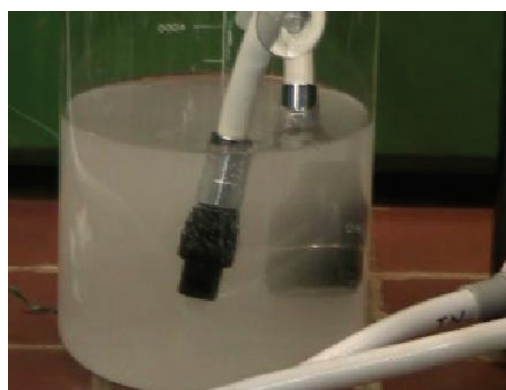
図 2.1.1-1 マイクロバブルの発生状況 (加圧溶解法、産総研 高橋研にて撮影)
