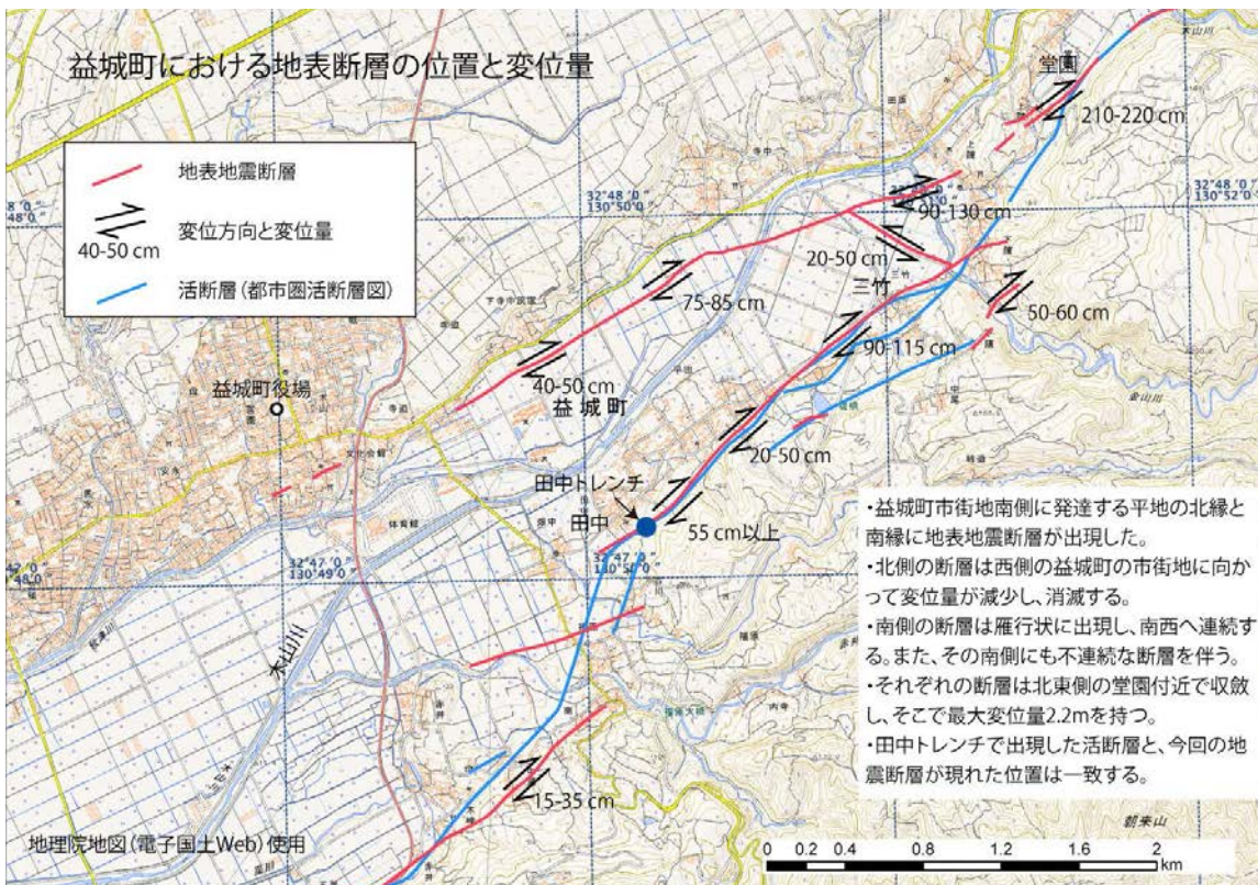
図 3.1-15 益城町における地表地震断層の位置と変位量 (産業技術総合研究所, 2016)
