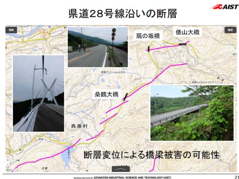
図 3.1-24 断層変位による橋梁被害の可能性（吉見，2016）
