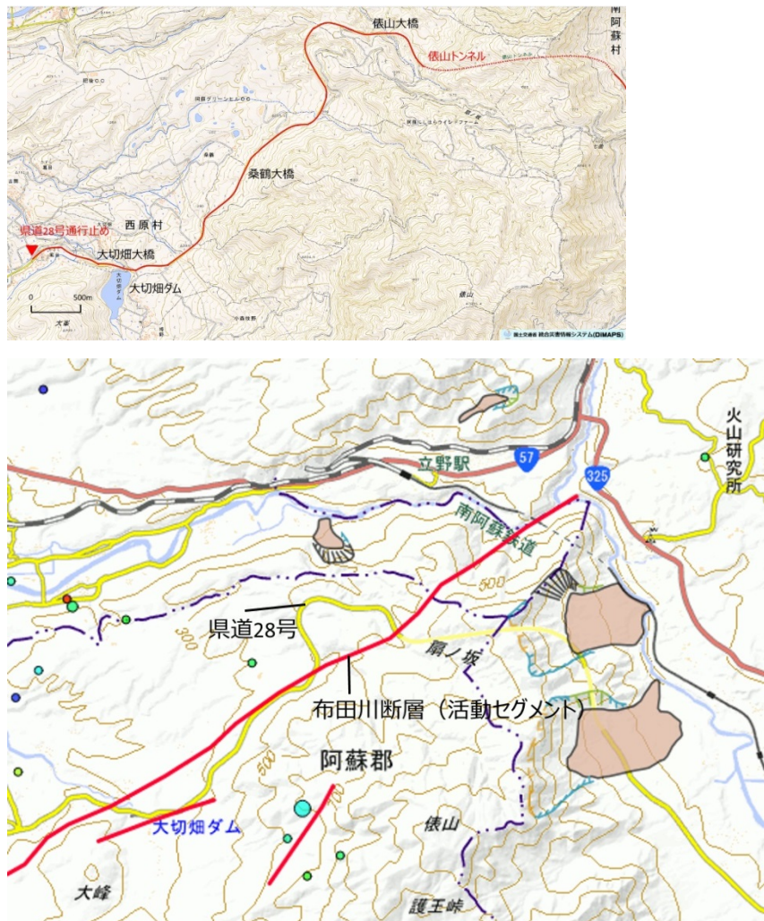
図 3.1-17 俵山トンネルと布田川断層の位置関係（日経コンストラクション，2016）
