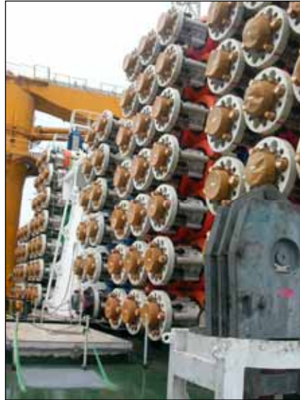
「ちきゅう」船尾に搭載されたライザーパイプ (外径1.2m、長さ27m)
