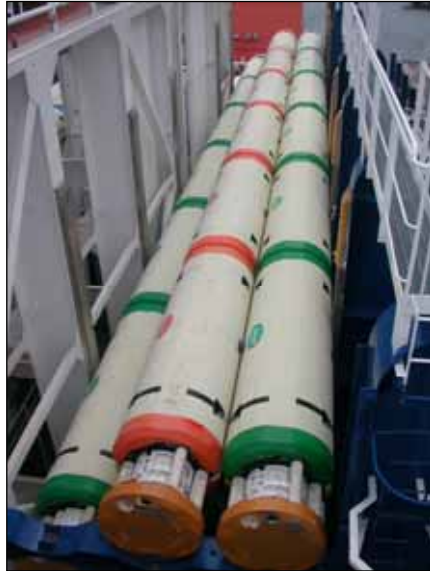
「ちきゅう」船尾に搭載されたライザーパイプ (外径1.2m、長さ27m)
