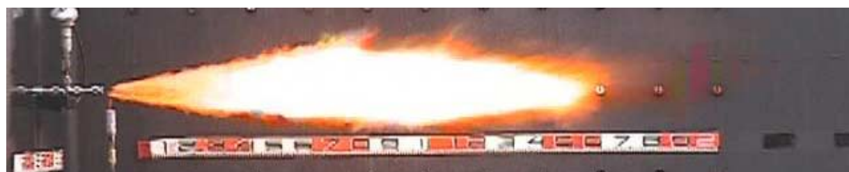
図 2.2.2-1 水素噴出火炎の例 (Na による炎色反応にて可視化) (ノズル口径: 1 mm 火炎長さ: ~1.7 m)
